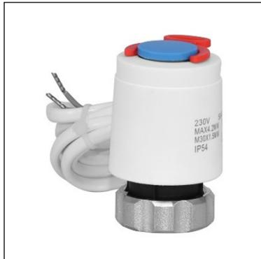
Elektroterminė pavara A230NC (normaliai uždaryta) skirta šildymo, vėsinimo sistemos termostatinių vožtuvų ar kolektorių valdymui. Ji gali būti valdoma valdikliu išduodančiu signalą įjungta / išjungta arba jungikliu.
